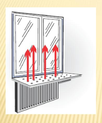
Если в подоконной доске просверлить отверстие, то теплый воздух от батарей, через проходя будет отверстия, создавать естественную тепловую завесу.
