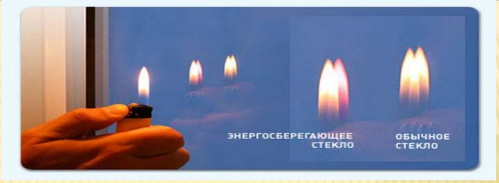
На рынке продаж появляются окна с теплосберегающим стеклом. Это полированное стекло на которое с использованием технологии вакуумного напыления нанесено покрытие из оксидных металлов. Продукт был специально разработан для использования в стеклопакетах, которые отличаются повышенными показателями теплосбережения, а также отличной пропускной способностью солнечного света и прозрачностью. Данные стеклопакеты продаются по той же цене, что и с обычным стеклом.
