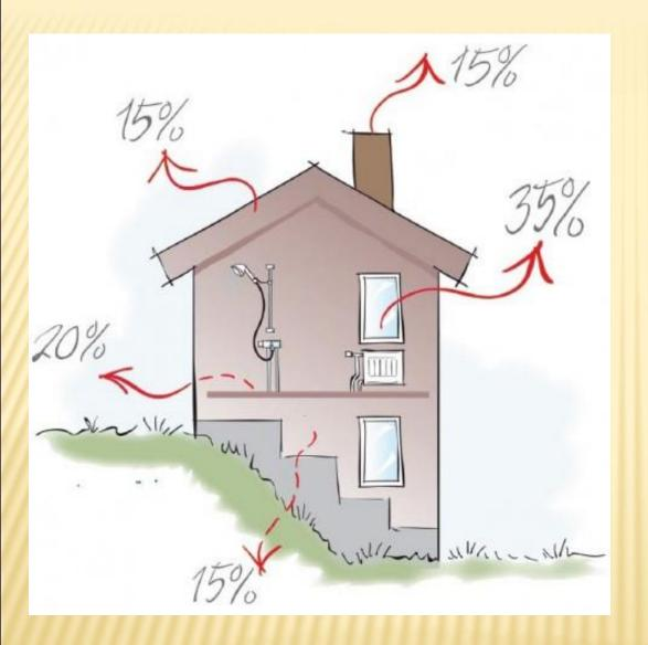
Через стены и окна происходит передача тепла на улицу. Происходит это примерно в тех пропорциях, которые указаны на рис.1.
